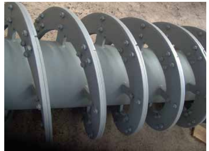
Espiras reforzadas y atornilladas en acero antidesgaste de fácil recambio.
